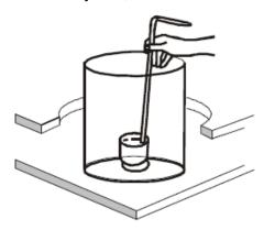
4.2. Заполните чашу, удерживаемую манипулятором, топливом FANOLA®. Избегайте переливания топлива через край чаши. Заливайте топливо очень аккуратно, т.к. пролитое топливо может привести к пожару. Воспламенение топлива, пролитого на изделие, может вызвать появление трещин на цилиндре.
