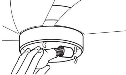
**11.** Установите лампу (тип E14 и макс. мощность не более 60 Вт для ламп накаливания).
