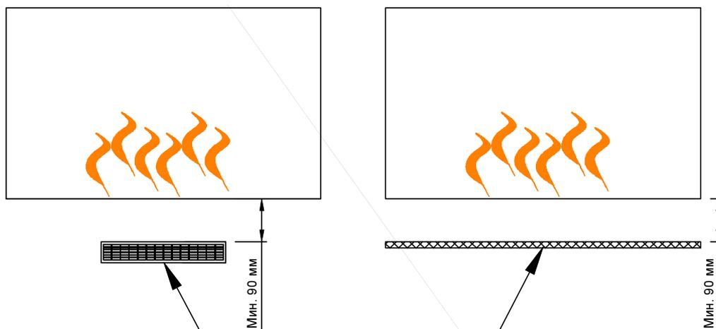
Вентиляционная решетка может быть любого размера и формы, но следует помнить, что площадь ее должна быть не менее 150 см<sup>2</sup>, а расстояние до верхней кромки кожуха - 90 мм.
